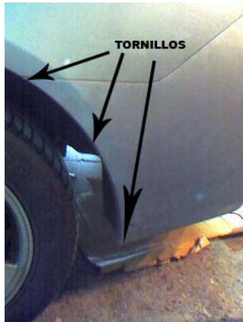
2. Desmontar la tapa de protección de plástico negra inferior: 2 tornillos + 2 grapas.
