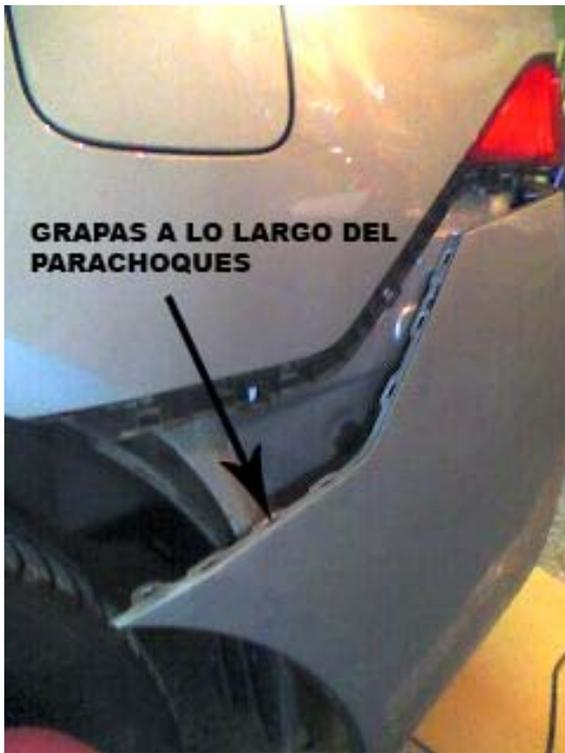
4. Con el parachoques desmontado, limpiar la superficie donde se va a pegar la antena. Pegar la antena empezando desde la parte del conductor, a 10 o 15 cm de la esquina trasera izq del parachoques, hasta el otro lado.
