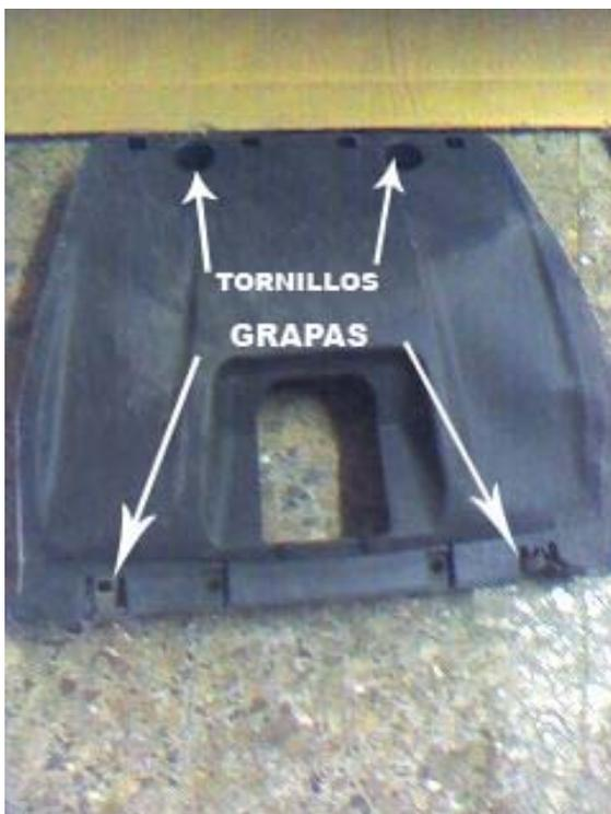
3. Tirar del parachoques hacia fuera para que salten las grapas. Empezando por el lateral izq y acabando por el derecho (tranquilos no se rompen)
