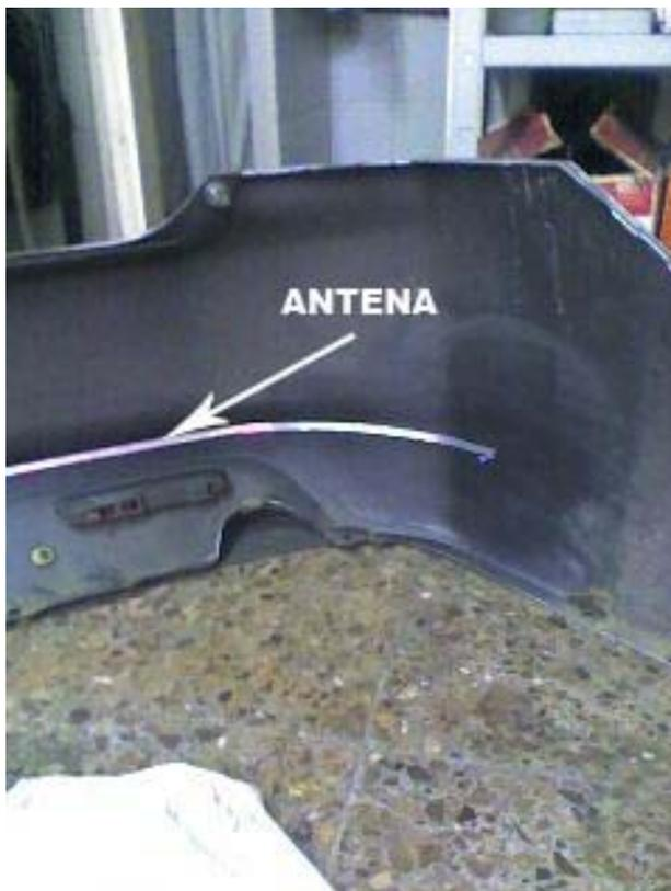
5. Fijar la central al parachoques y conectar la antena y la central.
